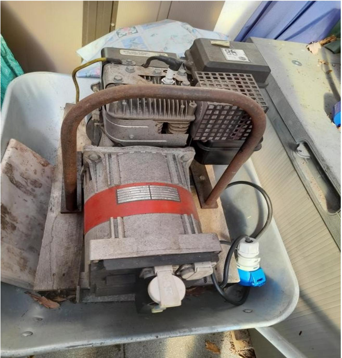
**Abb. 10:** "Mobiler" Endress-Generator in der Schubkarre. Man lasse sich durch den rostigen Griff und Auspuff nicht täuschen. Er springt meistens beim ersten Zug an, verliert kein Öl und läuft und läuft, wenn auch laut.
